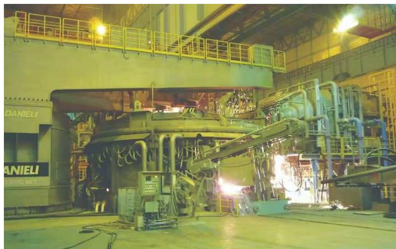
リサイクルには電炉を活用し、高炉を使う場合よりもCO2排出量を約75%削減する
